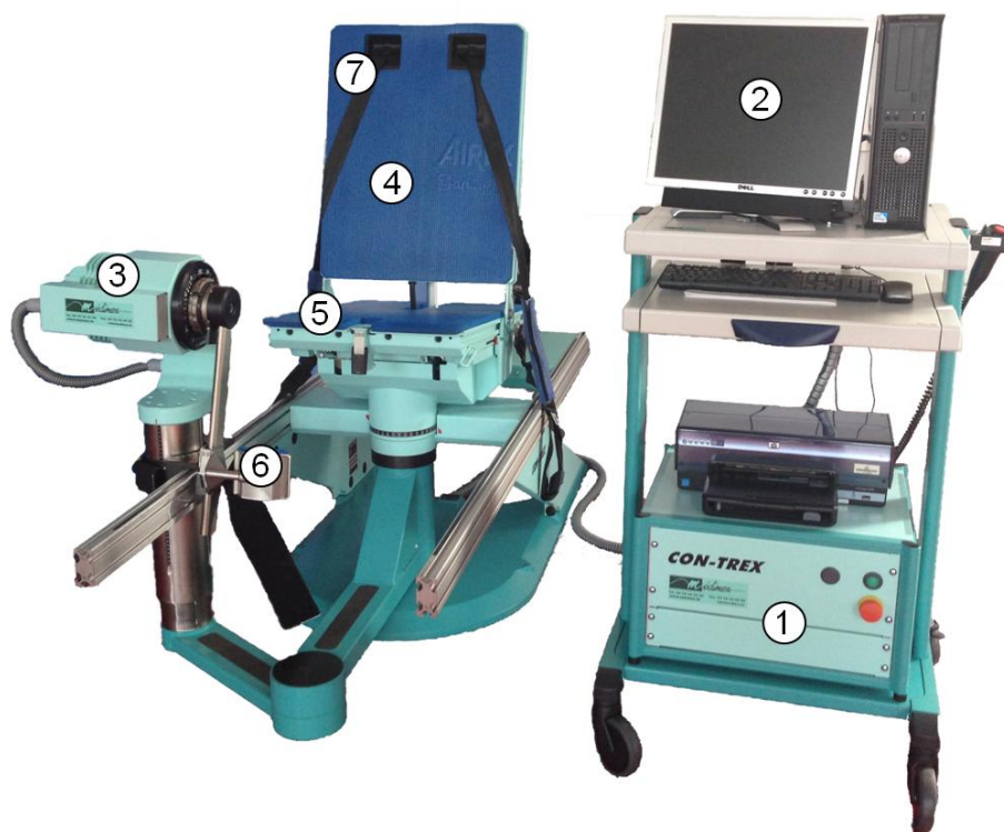
Figure IV.2.4. Ergomètre Con-Trex. 1- unité de contrôle et de puissance, 2- ordinateur et écran de contrôle, 3- ergomètre imposant les résistances et mesurant les sorties mécaniques, 4- assise réglable, 5- siège réglable, 6- accessoire genou, 7- sangles de maintien.
