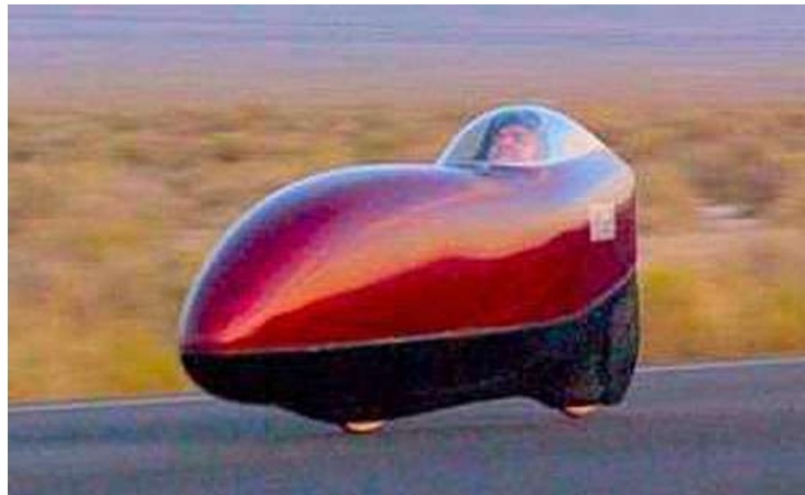
Figure L. Vélo couché de type « Varna Diablo » autorisé par l'IHPVA. Sam Whittingham, actuel détenteur du record de l'heure, de 90,6 km, utilisa ce modèle de vélo non conventionnel [91].
