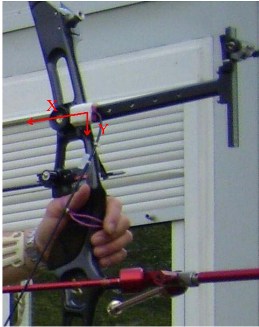
Fig.17. capteur1 fixé sur l'arc
