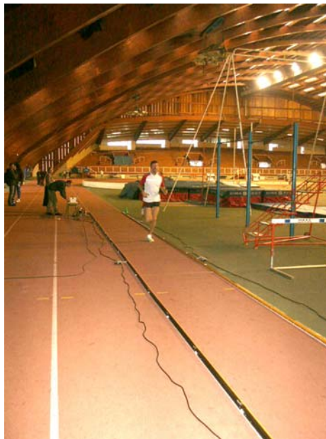
Photo 3 : Test de course à différentes vitesses avec l'optojump et la plateforme de force.
