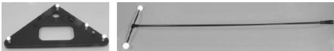
Figure 5 : Triangle de calibrage statique et tige de calibrage dynamique (avec 2 mires)
