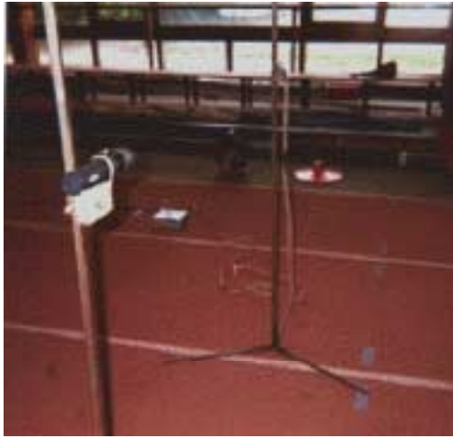
Figure 1-1 : Cellule pour l'arrêt du chronomètre
