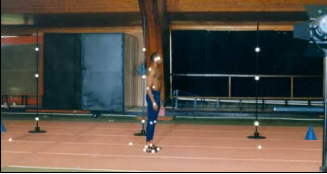
Figure 1-1 : Calibration de la plate-forme, calibration de l'espace et emplacement des mires
