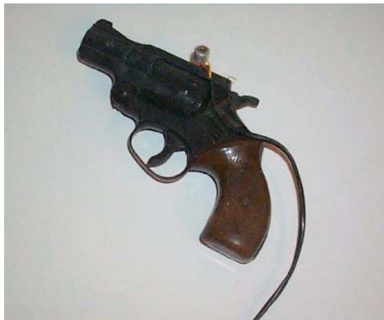
Le capteur positionné sur une pistolet de départ
