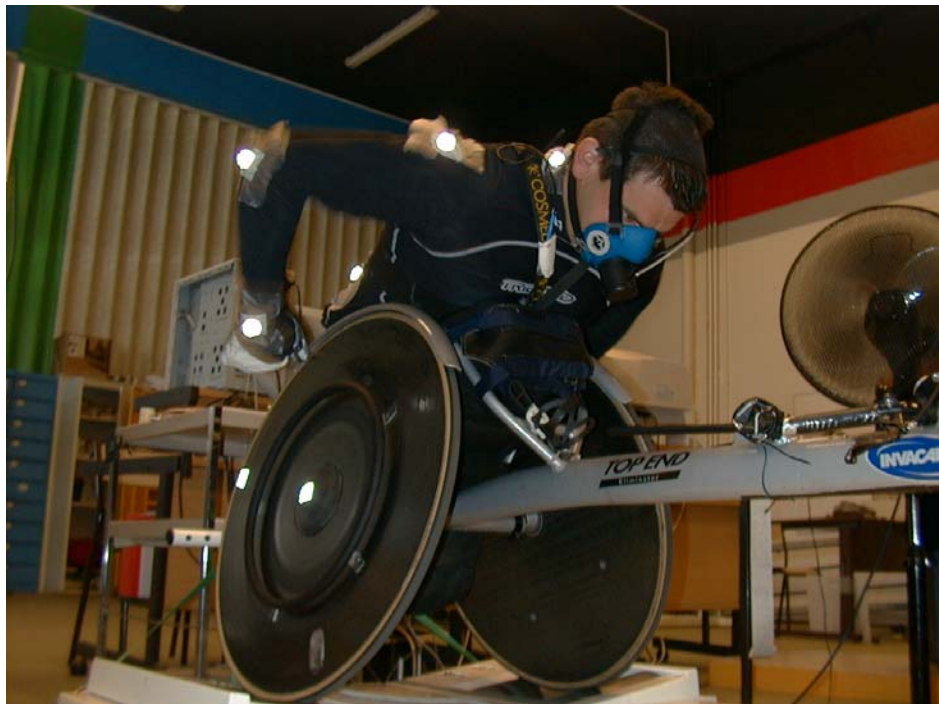
Photo 4 : Dispositif expérimental mis en place pour l'analyse cinématique. Six marqueurs sont positionnés sur le côté droit : axe de la roue, pneu, poignet, coude, épaule et cou
