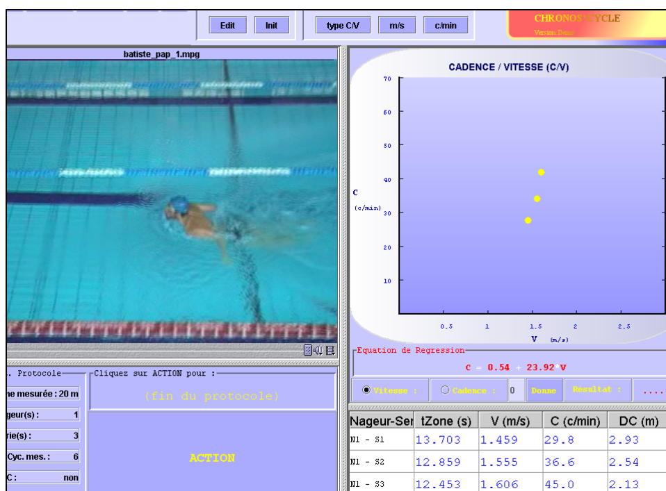
Diapositive 10 : Affichage immédiat dès la fin du test des Temps, Vitesses, Cadences, Distances par cycle ainsi que les points sur le graphique illustrant l'équation Cadence/Vitesse établie en « temps réel ».
