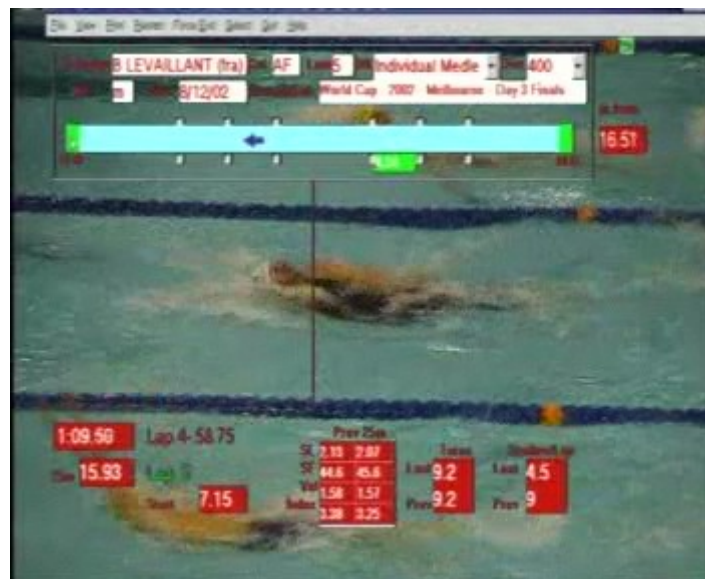
Diapositive 5 : Système « léger » australien. Le résultat de la course ainsi encodé sur disque dur est disponible dès la fin de la course. Apparaissent pour chaque longueur de bassin : distance par cycle, cadence, vitesse, indice de nage, temps sur le virage précédent etc.
