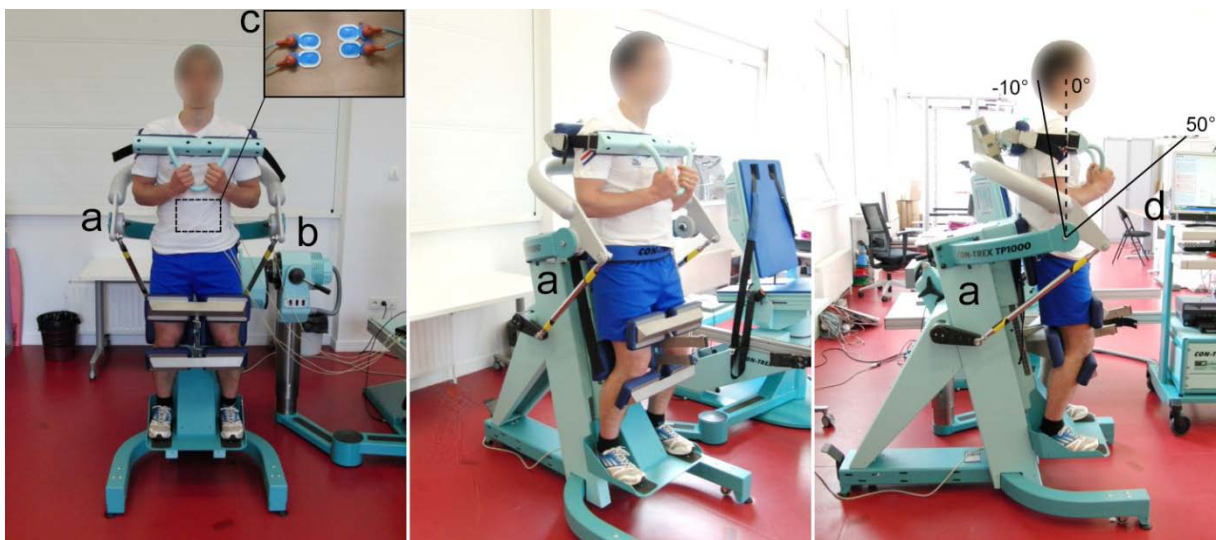
Fig. 19. Vue de face, de côté et de haut du module tronc Con-Trex TP-1000 (a) connecté au moteur (b). L'activité musculaire des muscles rectus abdominis (c) and erector spinae était enregistrée et synchronisée avec les mesures mécaniques issues de l'ergomètre.
