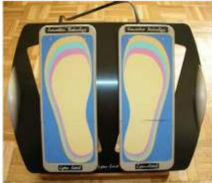
Nous avons utilisé les sabots dynamométriques "CyberSabots" d'Innovative Technology (Brevet No : 9915033 ; Ouaknine, 1999). Chaque sabot est constitué de 2 surfaces équipées de capteurs qui enregistrent séparément les appuis du talon et de l'avant pied. Les 2 sabots indépendants l'un de l'autre peuvent être positionnés en configurations libres ou dans les gabarits prévus conformes aux standards de l'école française (30°) et portugaise (0°).
