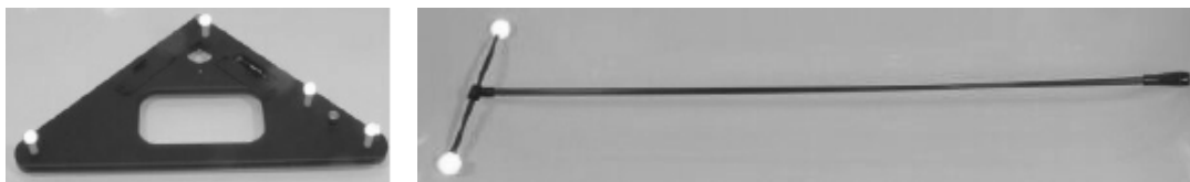
Figure 5 : Triangle de calibrage statique et tige de calibrage dynamique (avec 2 mires)
