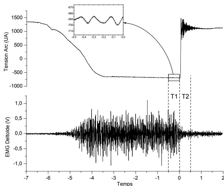
*Enregistrement expérimental de la déformation des branches de l'arc et de l'activité électromyographique du muscle deltoïde postérieur. La régularité de la phase de tiré est évaluée lors de la phase T1, et l'activité myoélectrique des muscles est calculée lors des phases T1 et T2, soit 500ms avant et 500ms après la libération de la flèche.*
