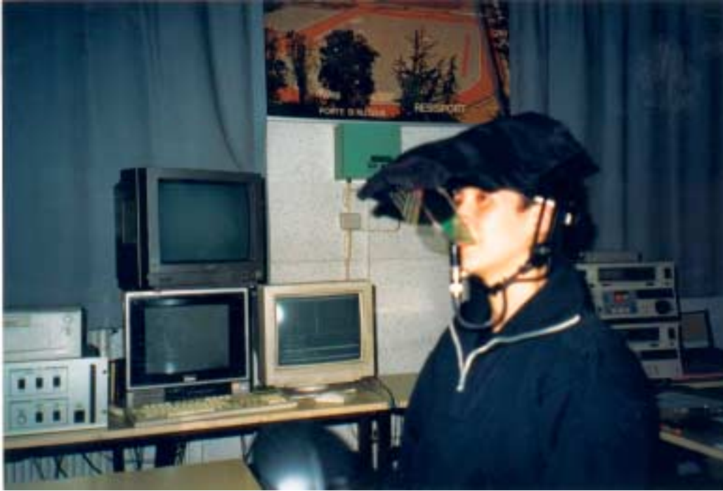
Figure 2 : Vidéo oculographe ASL utilisé pour l'expérimentation.
