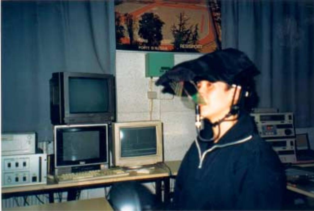
Figure 2 : Vidéo oculographe ASL utilisé pour l'expérimentation.
