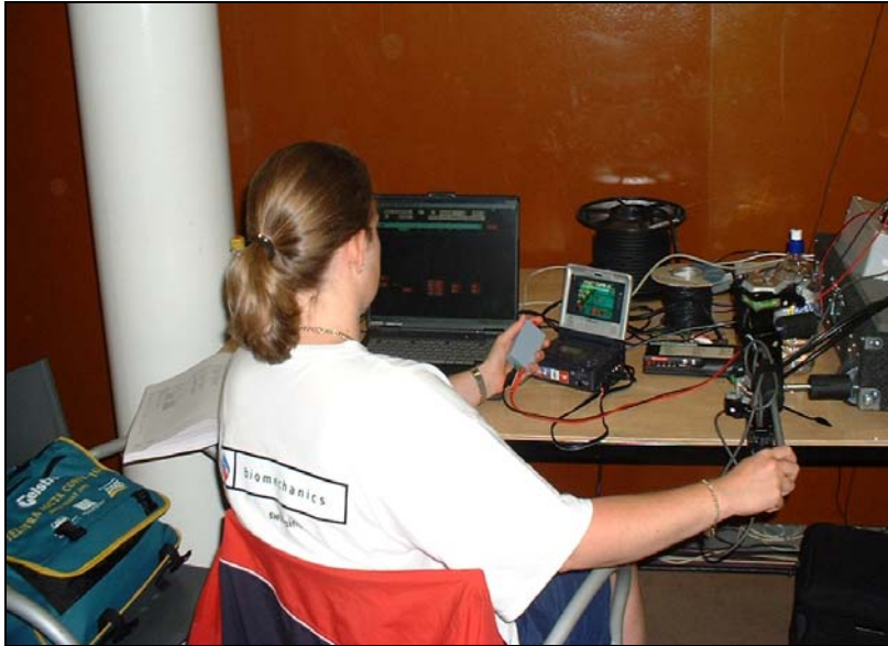
Diapositive 4 : Système « léger » australien. L'opératrice « suit » le nageur par vidéo (main droite) et marque chaque « coup de bras » par une action sur le bouton poussoir (main gauche) tandis qu'elle initialise chaque longueur de bassin avec le pied !
