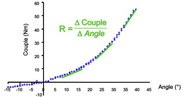
**Fig. 2.** Relation couple passif – angle articulaire obtenue lors de la mise en tension des muscles postérieurs de la cheville. La raideur du SMA est représentée par la pente de la tangente en chaque point de la relation.
