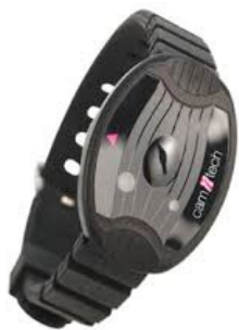
Figure 1 - Exemple de nouvelle génération d'actigraphe. Le modèle MotionWatch (© CamNtech, Cambridge, UK) intègre un accéléromètre tri-axial permettant de quantifier les mouvements.
